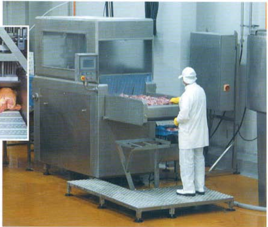
En la planta de Ariztia, la inyectora de Metalquimia, con tecnología de punta, marina la carne de pollo, por efecto "spray".
